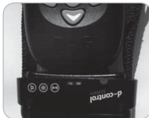
*Stellung beim Ein-/Ausschalten des Empfängers und bei der Verbindung des Senders mit dem Empfänger.*
